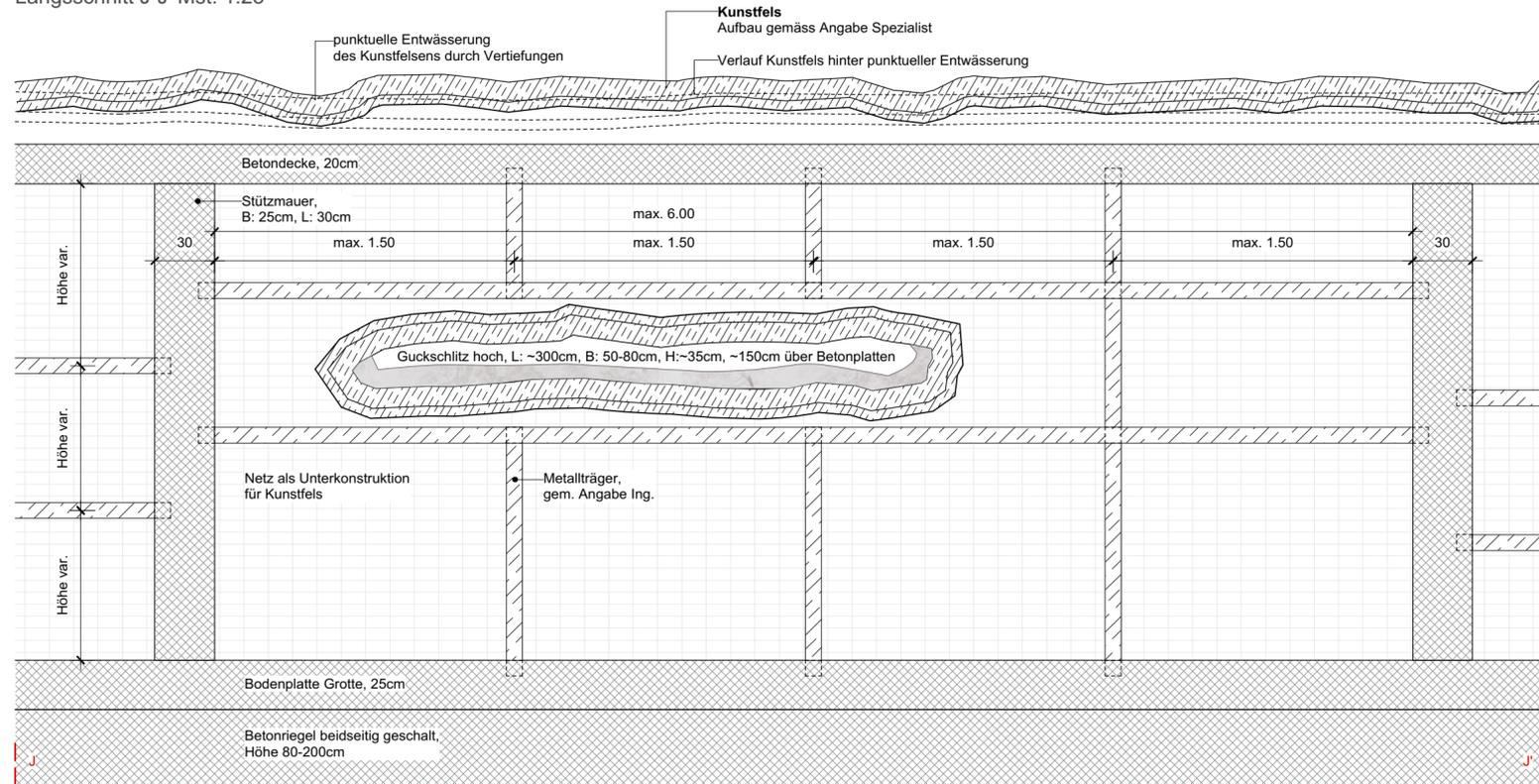
Regelschnitt Metallträger alternativ Form Guckschlitz
