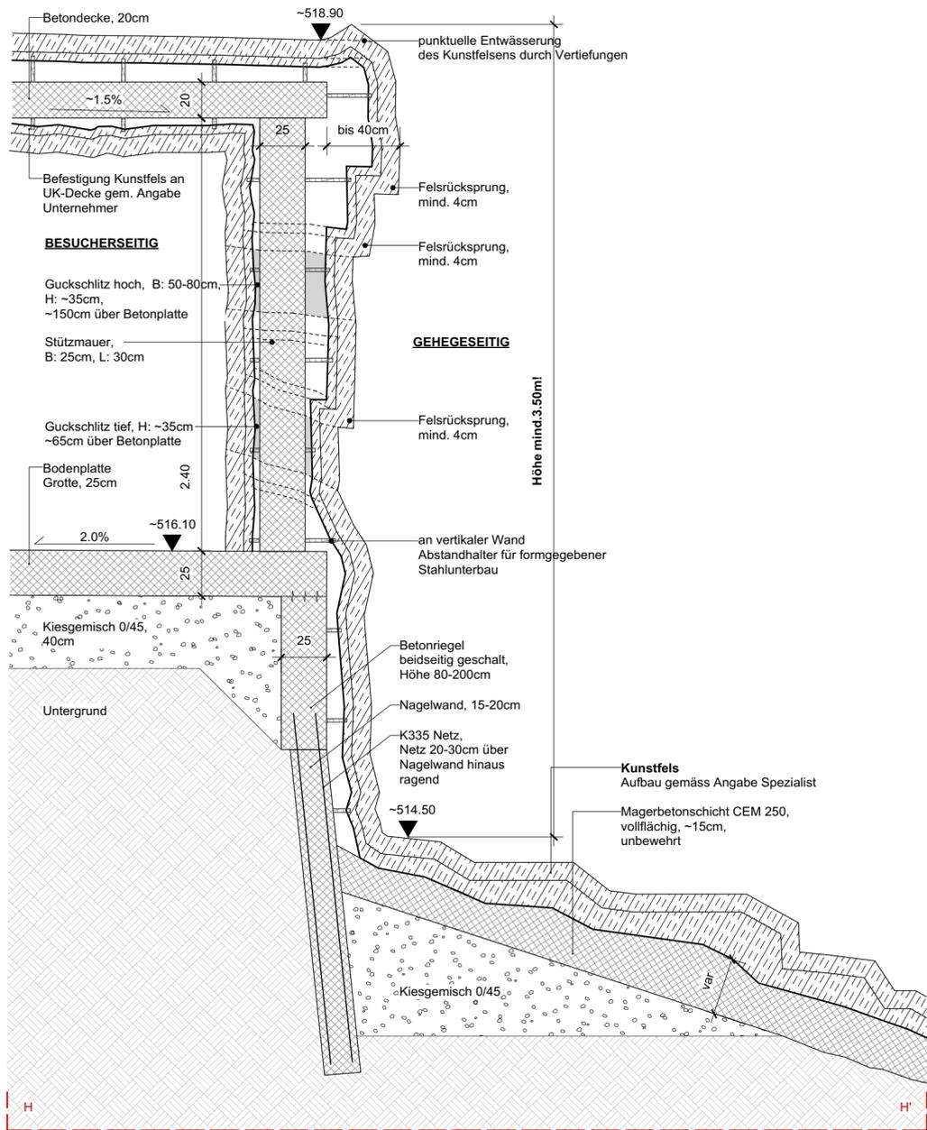
Regelschnitt Metallträger Guckschlitz
