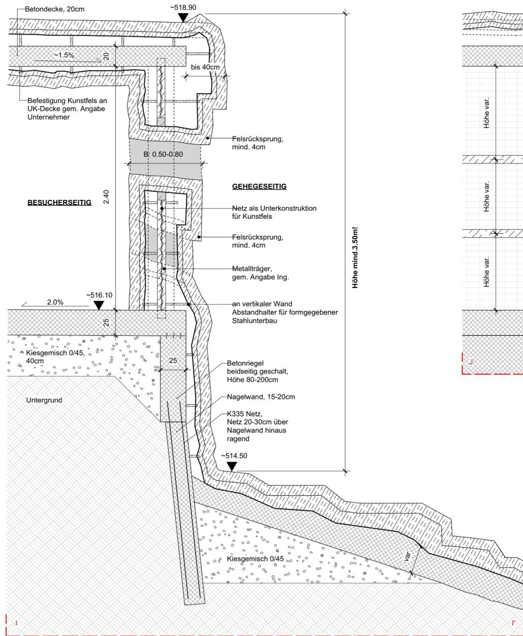
Regelschnitt Metallträger Guckschlitz
